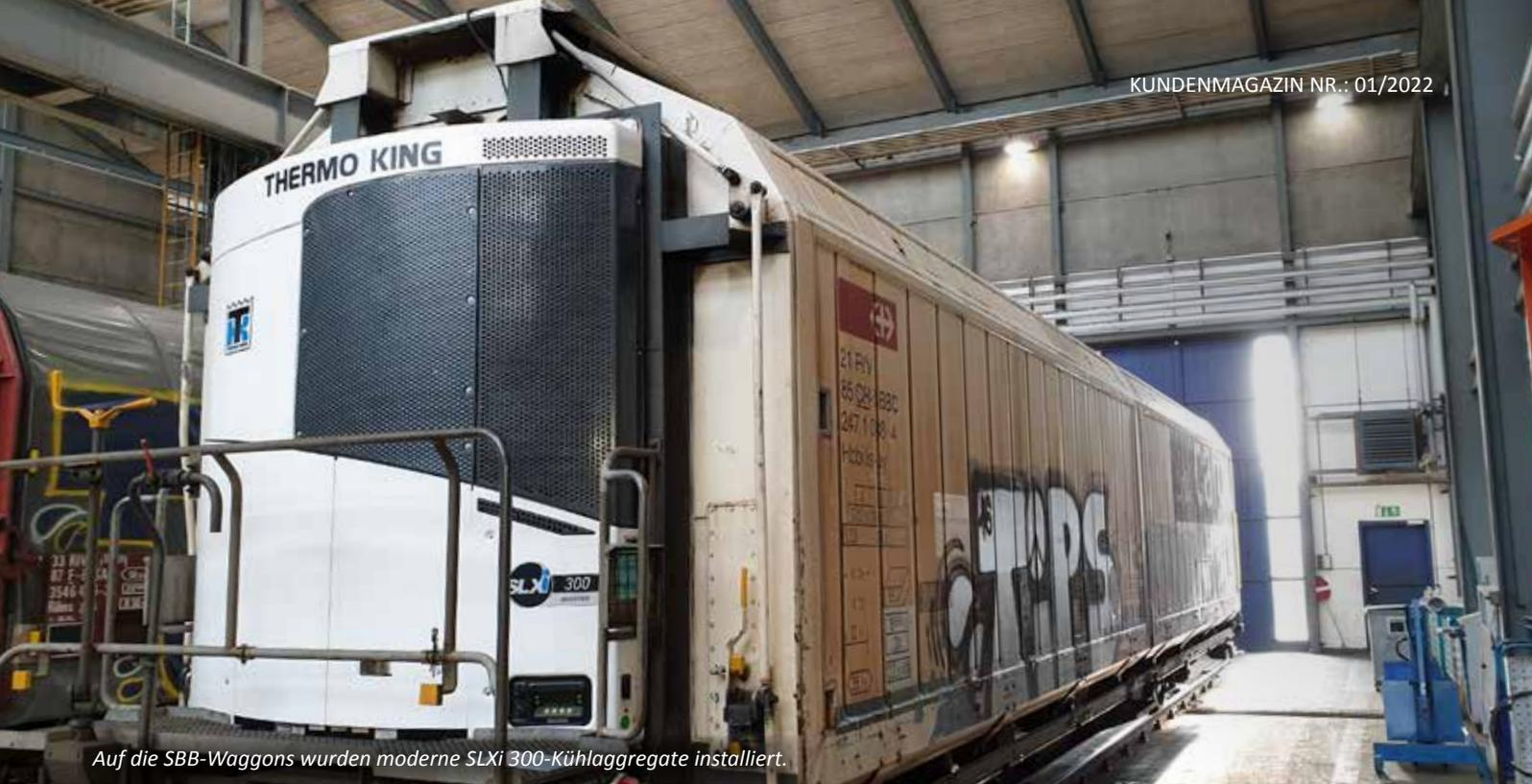
Auf die SBB-Waggons wurden moderne SLXi 300-Kühlaggregate installiert.
