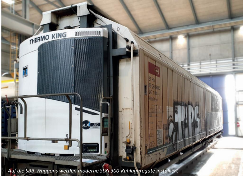
Auf die SBB-Waggons werden moderne SLXi 300-Kühlaggregate installiert
